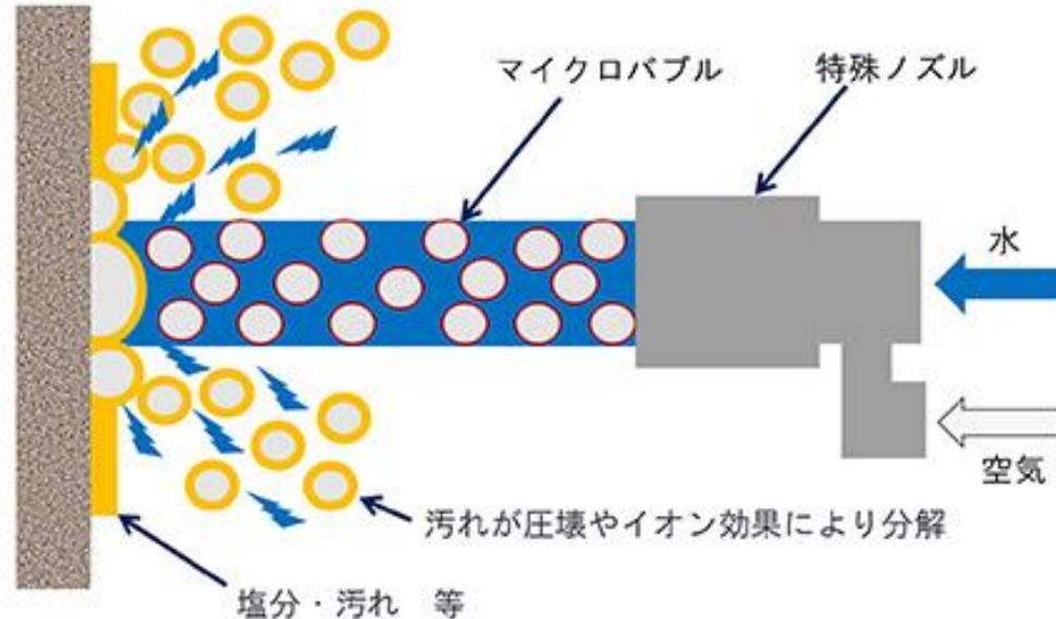
1. マイクロバブル表面が〔陰イオン〕に帶電しており、〔陽イオン〕の塩分や汚れが吸着・イオン結合することにより、付着塩分が物体の表面から剥離する。
