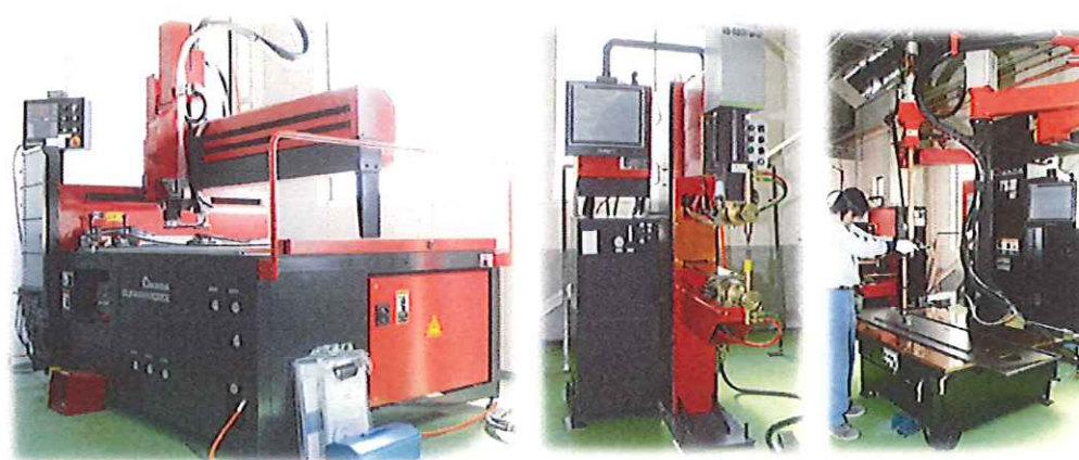
各種スタッド・スポット溶接機 (GUNMAN1000 II・ID40IVHP-NT・TS III-NT)
