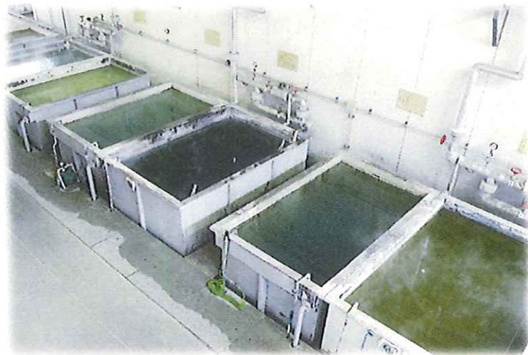
前処理工程(水洗・湯洗・アルカリ脱脂・酸洗・リン酸亜鉛皮膜処理)
