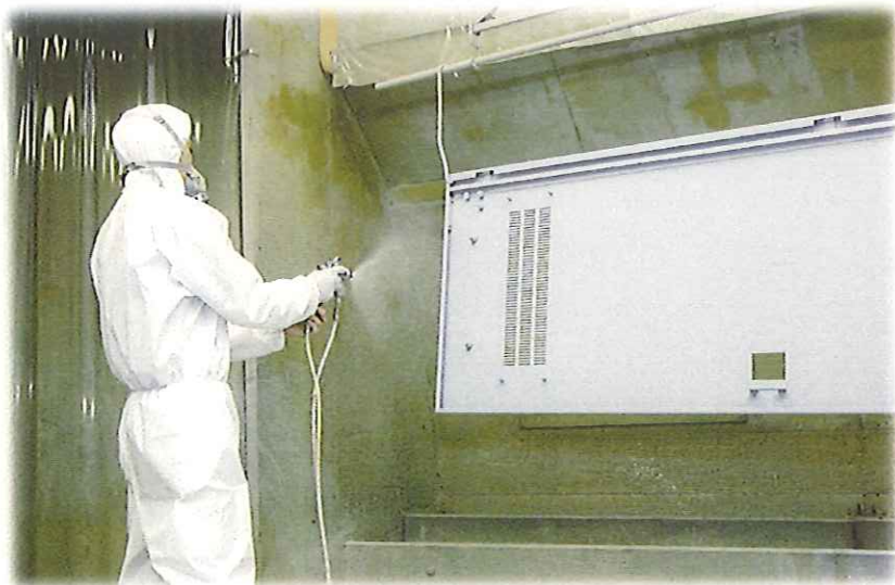
社内認定者による溶剤塗装作業
