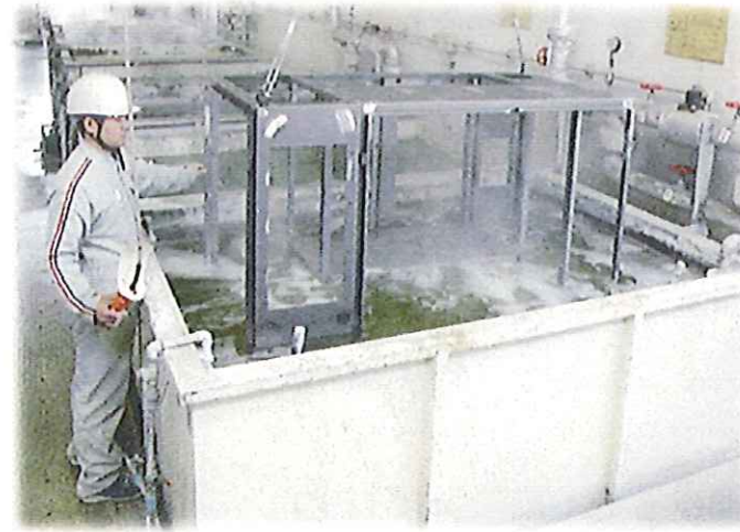
前処理工程(水洗・湯洗・アルカリ脱脂・酸洗・リン酸亜鉛皮膜処理)
