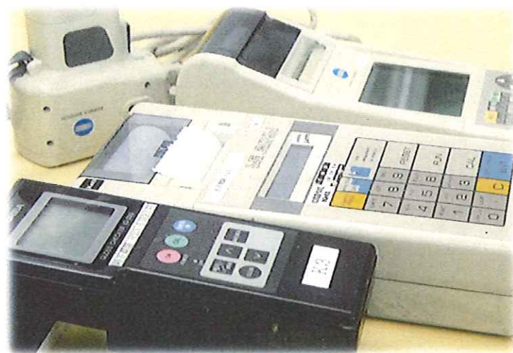
塗装検査機器(膜厚計・色差計・光沢計)
